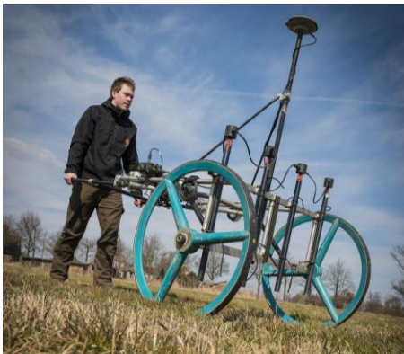
Afbeelding 4: meersonde metingen met handkar
