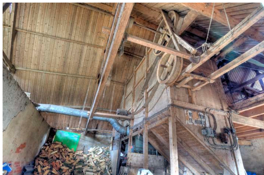
↓ Achterzijde van de kernen met rechts boven het drijfwerk van de elevator en de schroef.
