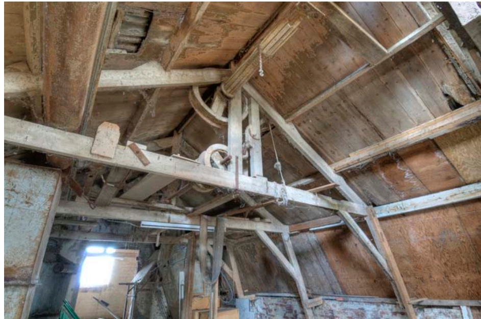
Drijfwerk in het rechter deel van de maalderij waar net onder de nok een zogenaamd 'luiwerk' hangt waarmee zakken via de kapel in de voorgevel opgehesen konden worden.
