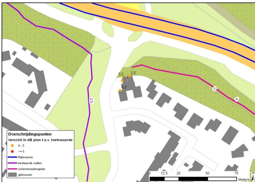
Figuur 6 Overschrijdingen [dB] ten gevolge van de Europaweg-Liemersweg na toepassing van overdrachtsmaatregelen en Dunne Deklagen type A (locatie tunnelmond).
