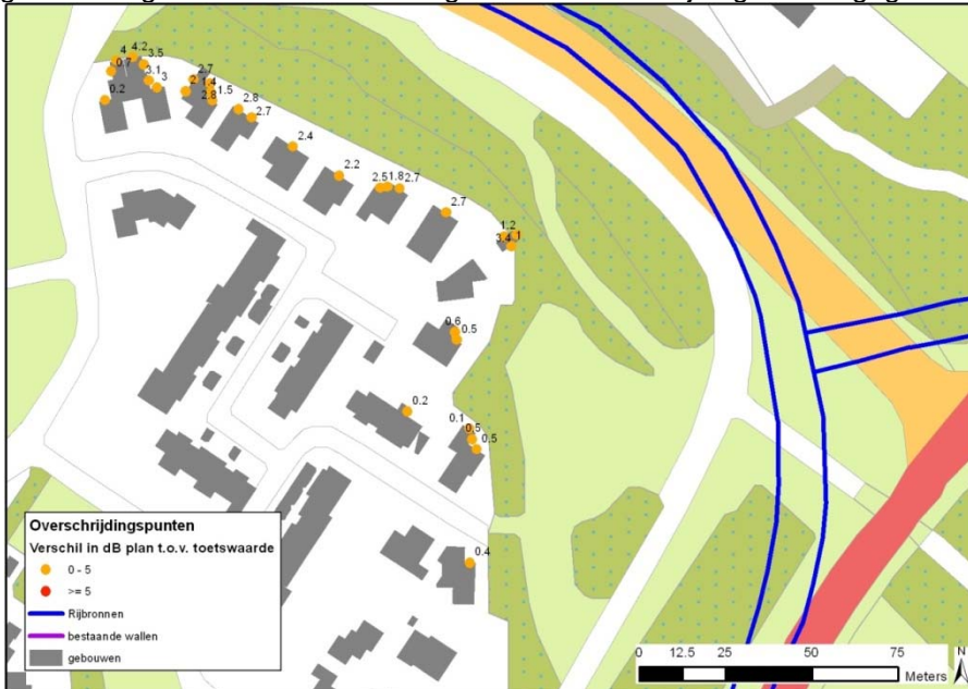
Figuur 4 Overschrijdingen [dB] ten gevolge van Europaweg-Liemersweg na toepassing van Dunne Deklagen type A (locatie tunnelmond).
