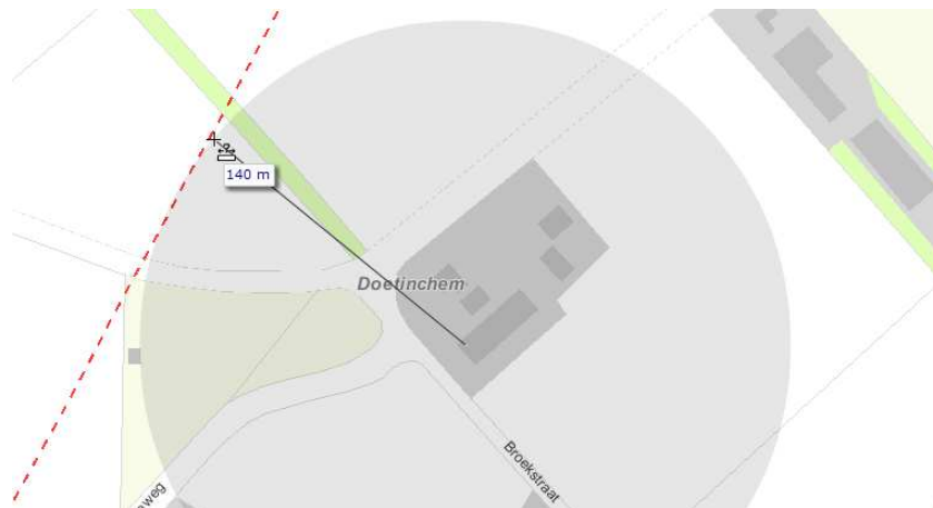
Figuur 4.2: Afstand buisleiding tot bebouwing
