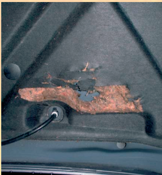
Hier is de isolatie van de motorkap beschadigd door een steenmarter
