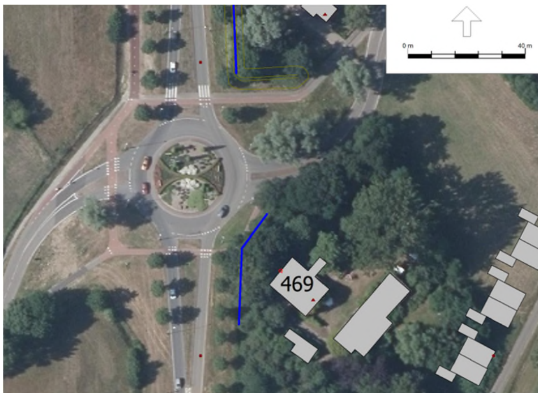
Afbeelding 5.1: Overdrachtsmaatregel oostelijke variant; geluidscherm (blauw) van 2 m. hoogte (zuid)
