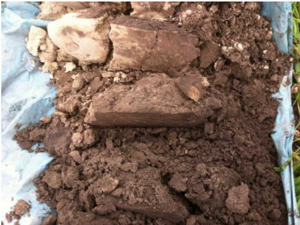
Boring 5: overgang humeus dek naar beekafzettingen.
