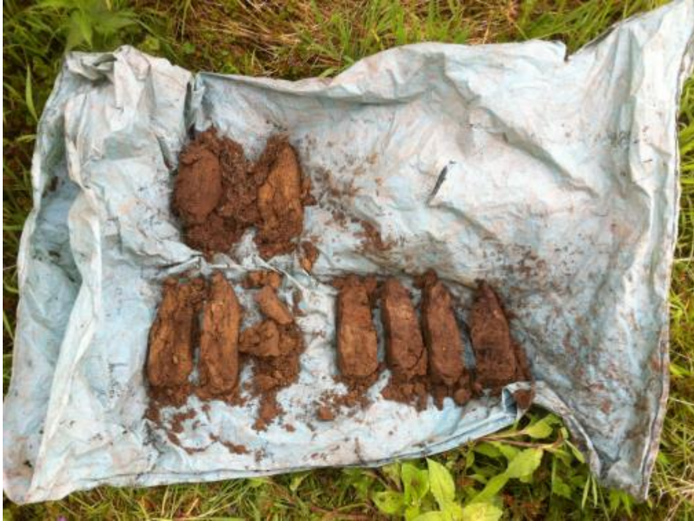
Boring 6: overzicht boorkernen top.
