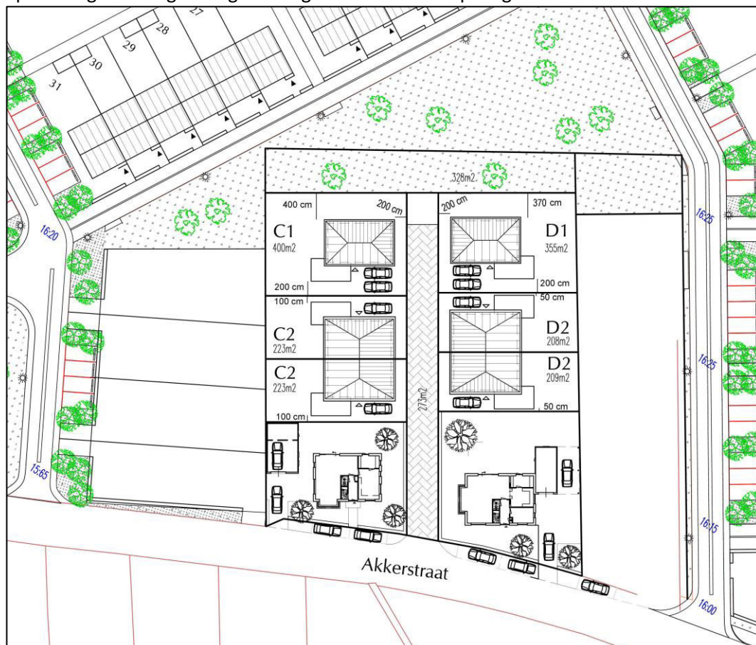
Afbeelding 3.1: Plattegrond toekomstige situatie (de twee vrijstaande woningen aan de Akkerstraat zijn bestaand)
