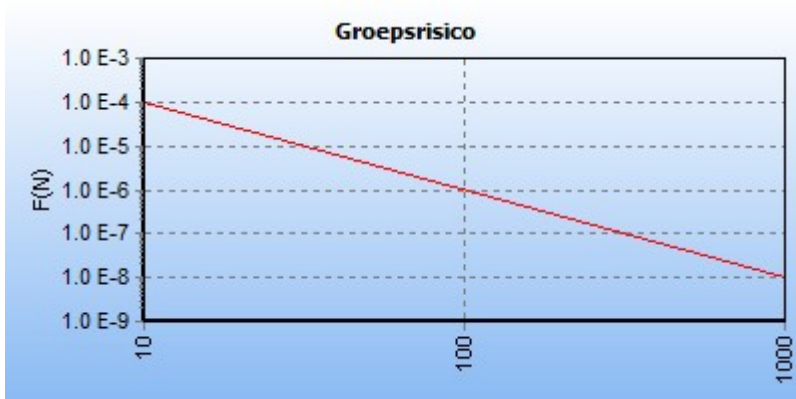
5.5 Figuur 5.5 FN curve voor 600_leiding-N-566-12-deel-1 van N.V. Nederlandse Gasunie voor de kilometer tussen stationing 1030.00 en stationing 2030.00
