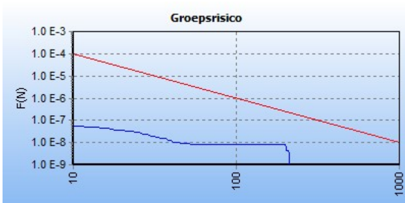
5.5 Figuur 5.5 FN curve voor 600_leiding-N-566-12-deel-1 van N.V. Nederlandse Gasunie voor de kilometer tussen stationing 1030.00 en stationing 2030.00
