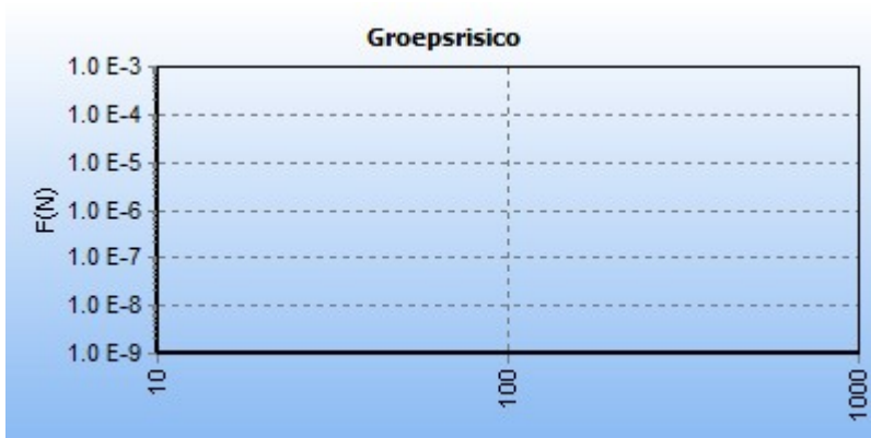
5.2 Figuur 5.2 FN curve voor 600_leiding-N-566-03-deel-1 van N.V. Nederlandse Gasunie voor de kilometer tussen stationing 1850.00 en stationing 2770.00
