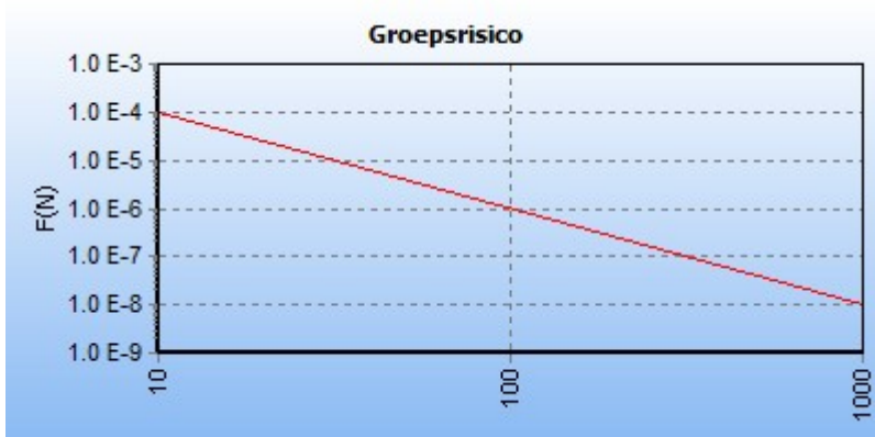
5.2 Figuur 5.2 FN curve voor 600_leiding-N-566-03-deel-1 van N.V. Nederlandse Gasunie voor de kilometer tussen stationing 1850.00 en stationing 2770.00
