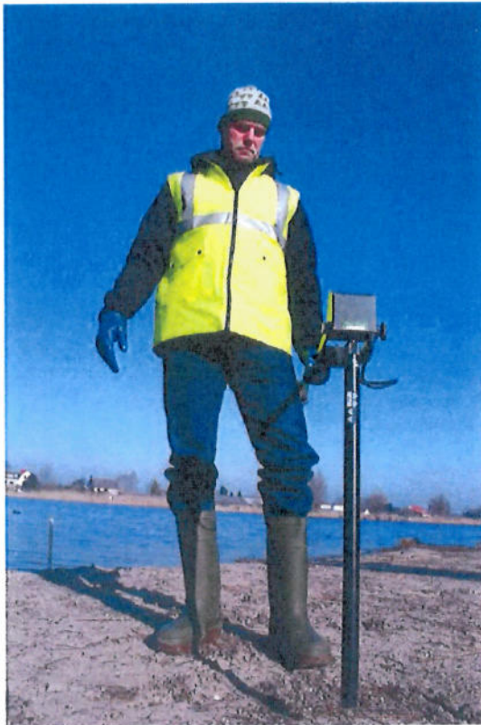
Figuur 1 Analoge detectie met magnetometer
