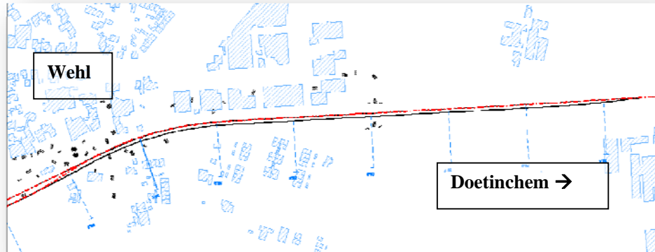
Figuur 3.2: Toekomstige sporenplan rondom Wehl (rood is het huidige spoor, zwart is het nieuwe spoor)
