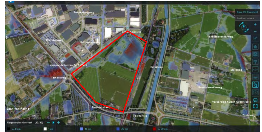
Figuur 10. water op maaiveld bij een bui van 60mm in 1 uur.
