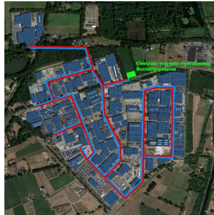
Figuur 13. Energieneutraal Eekterveld (zonnepanelen op de daken en koude-warmtepomp aan noordrand bedrijventerrein)
