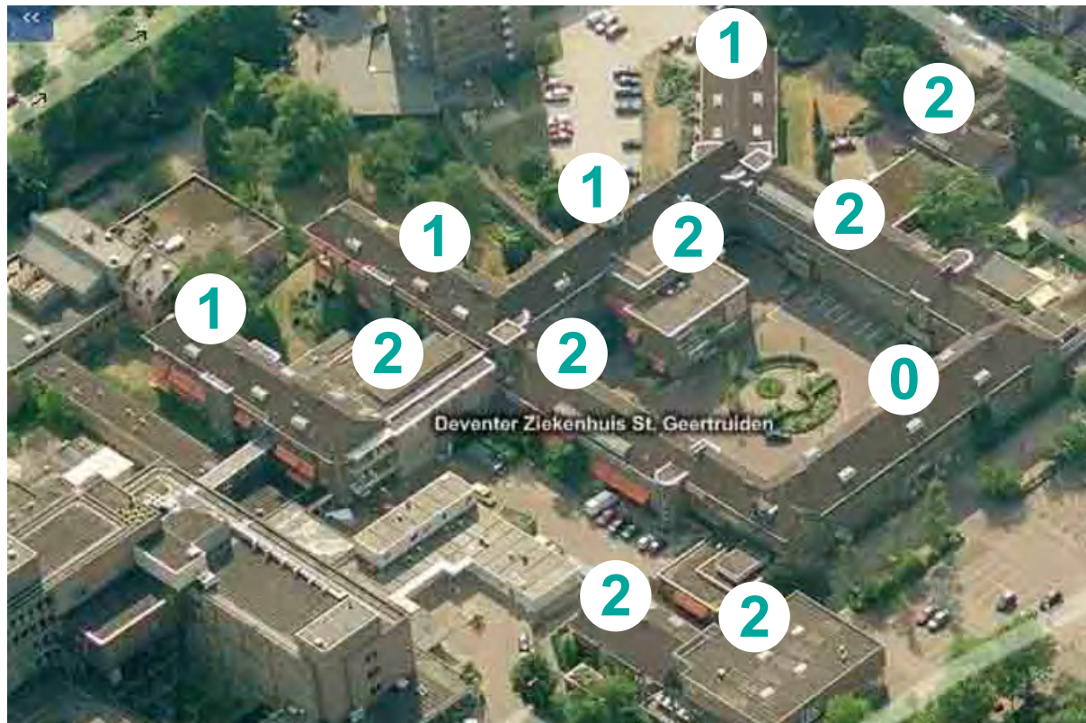
Figuur 4.14: aanduiding transformatieruimten SMCD-gebouw
