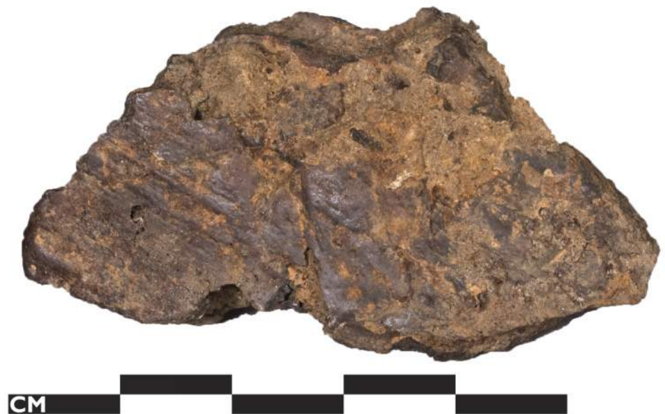
Afb. 6.6. In sommige kuiloven- en vloeislakken zijn nog houtindrukken te zien..
