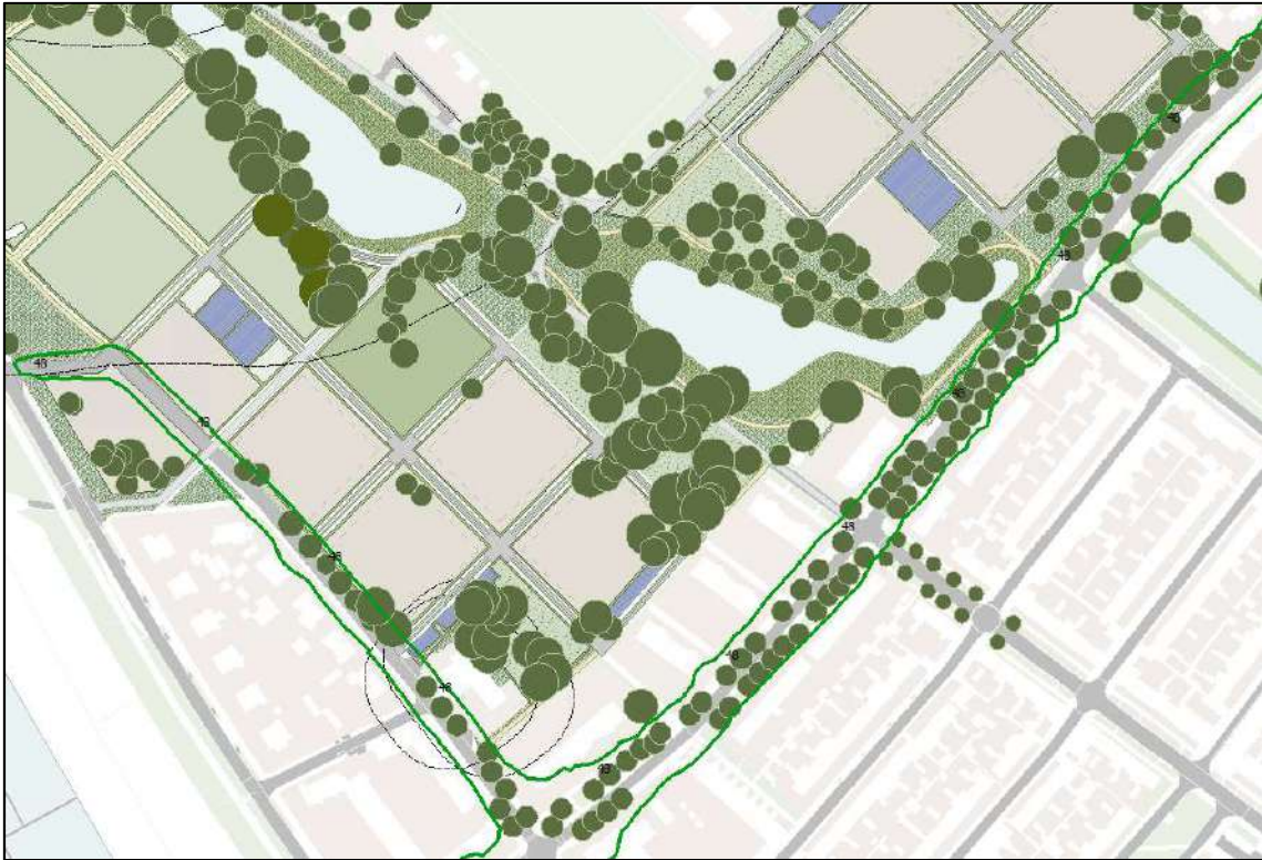
Figuur 8.7: berekende 48 dB L_{den} geluidscontouren vanwege de 30 km-wegen op een maatgevende waarnemhoogte h_o = +4,5 m (exclusief aftrek art. 110g Wgh)
