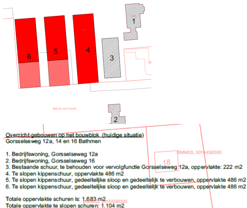
Figuur 4: Overzicht van de te slopen schuren
