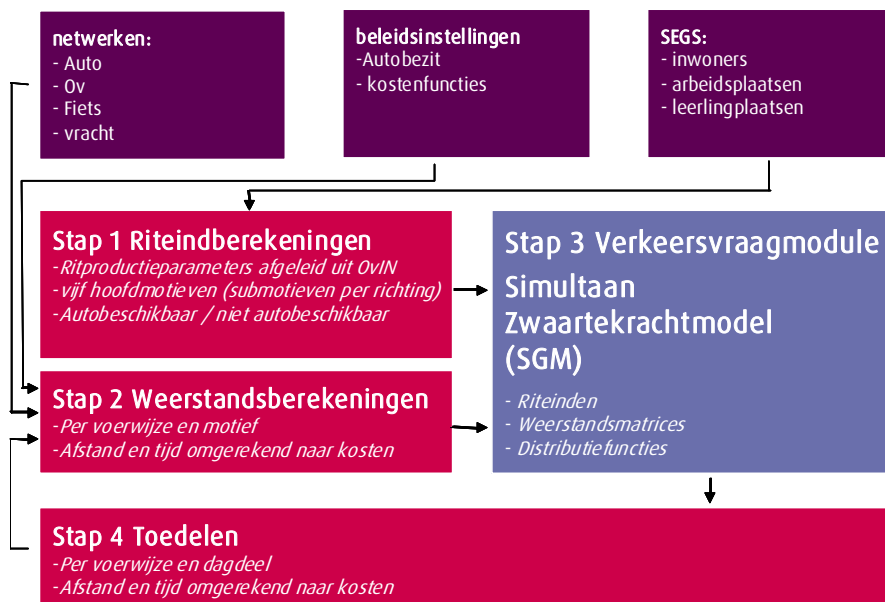
Figuur 2.2: De werking van een simultaan verkeersmodel
