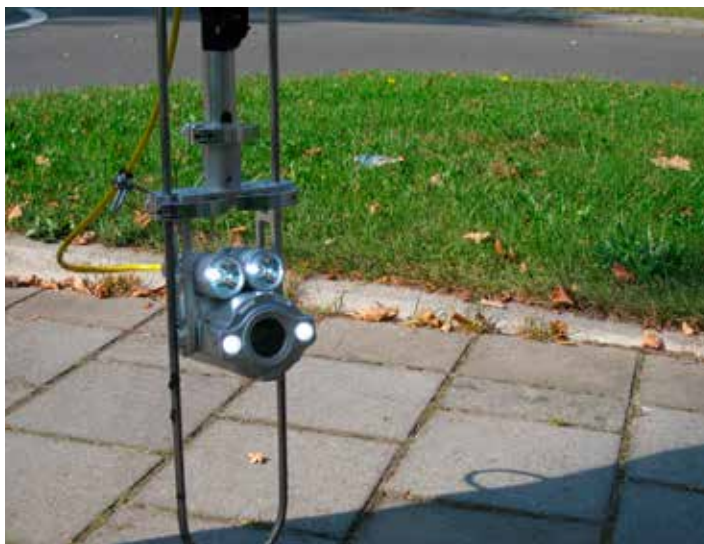
Inspectiecamera voor globale inspectie (2014)
