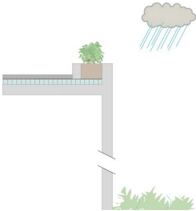
regenwater retentie op platte daken
