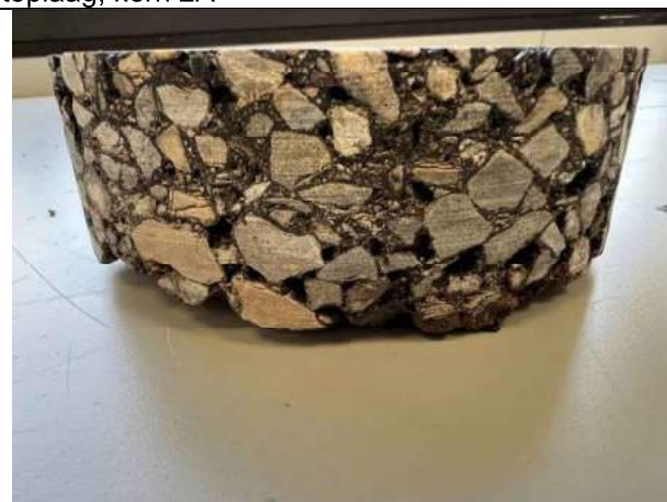
Onderlaag - zeer open asfaltbeton (ZOAB 11/16)
