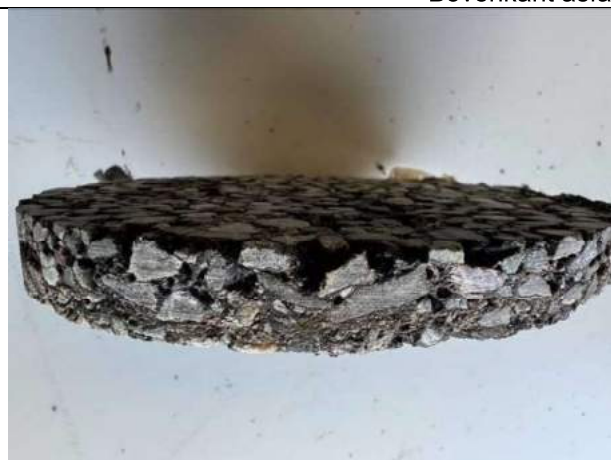
Toplaag - fijn zeer open asfaltbeton (ZOAB 4/8).
