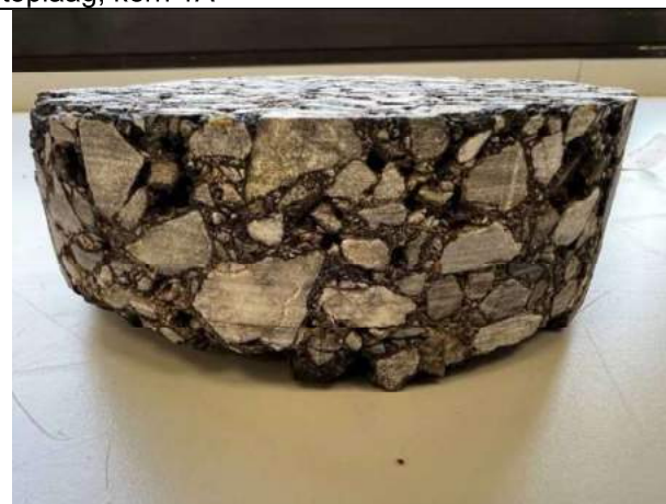
Onderlaag - zeer open asfaltbeton (ZOAB 11/16)
