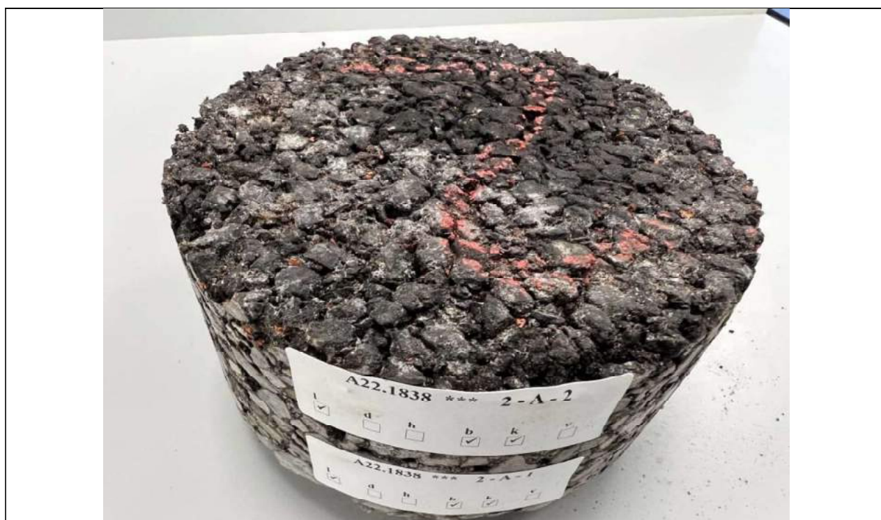
Bovenkant asfalt toplaag, kern 2A
