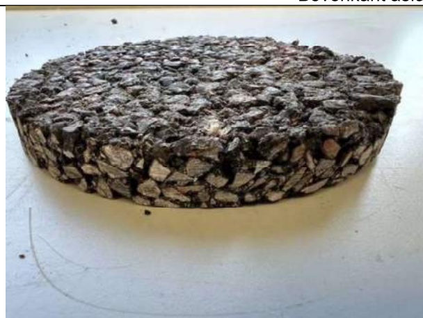
Toplaag - fijn zeer open asfaltbeton (ZOAB 4/8).
