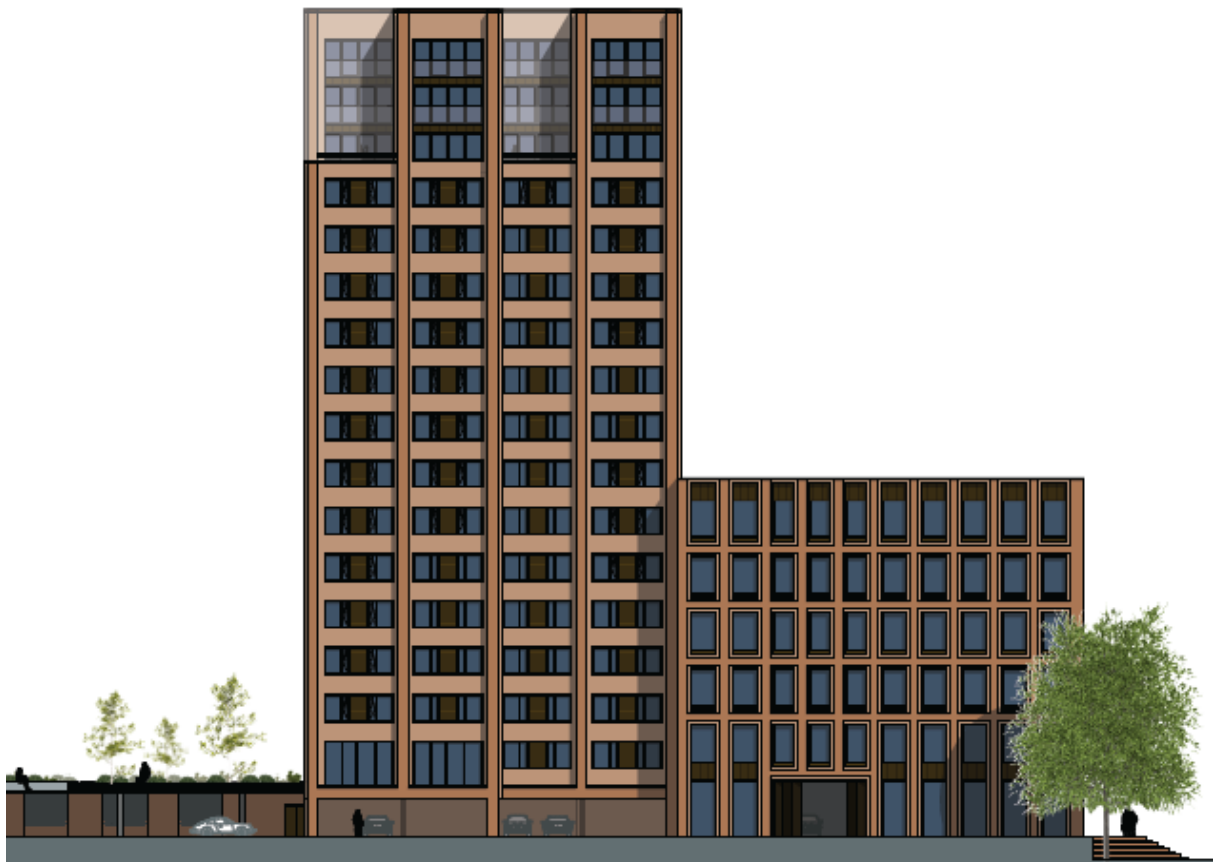
Figuur B. Gevels met Ducowall-lamellenrooster als voorziening ter geluidreductie railverkeerslawaaï (de donkere vlakken betreffen de Ducowall-delen)
