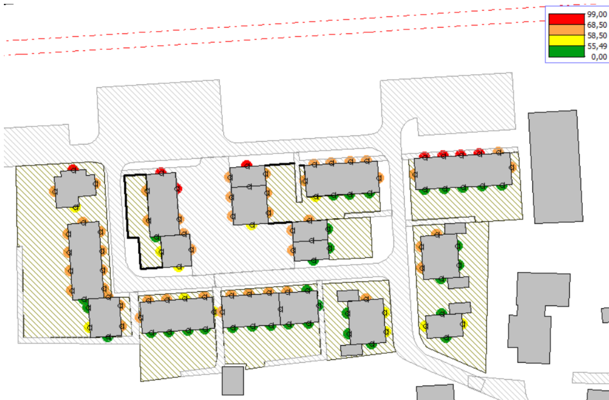
Afbeelding 4 - Overzicht rekenresultaten spoorweg zonder maatregelen- maximale geluidbelasting per gevel.
