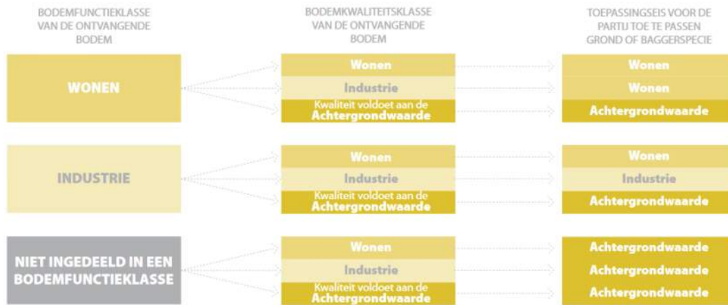
Figuur B1.1 Werking dubbele toets in het generieke kader. Bron: Handreiking besluit bodemkwaliteit via https://www.bodemplus.nl/onderwerpen/wet-regelgeving/bbk/instrumenten/handreiking-bbk/
