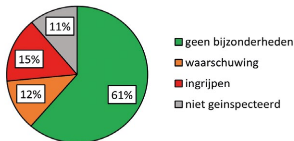
Figuur 5-3 Inspectieresultaten meest recente inspectie van alle vrijvervalriolen
