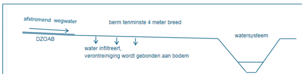
Figuur 10-1 Principeprofiel lozen op of in de bodem bij een berm van ten minste 4 meter
