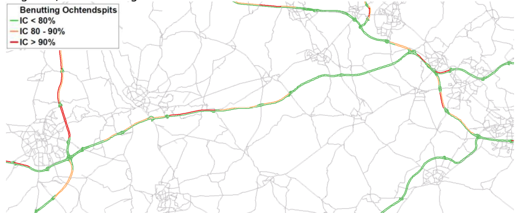
Figuur 5-7: I/C-verhoudingen ochtendspits in projectsituatie 2030H
