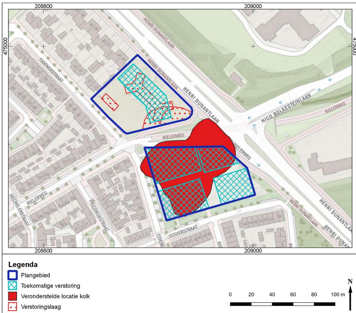
Afb. 1.5: De toekomstige bouwblokken met de funderingen van de flat en de veronderstelde locatie van de kolk.
