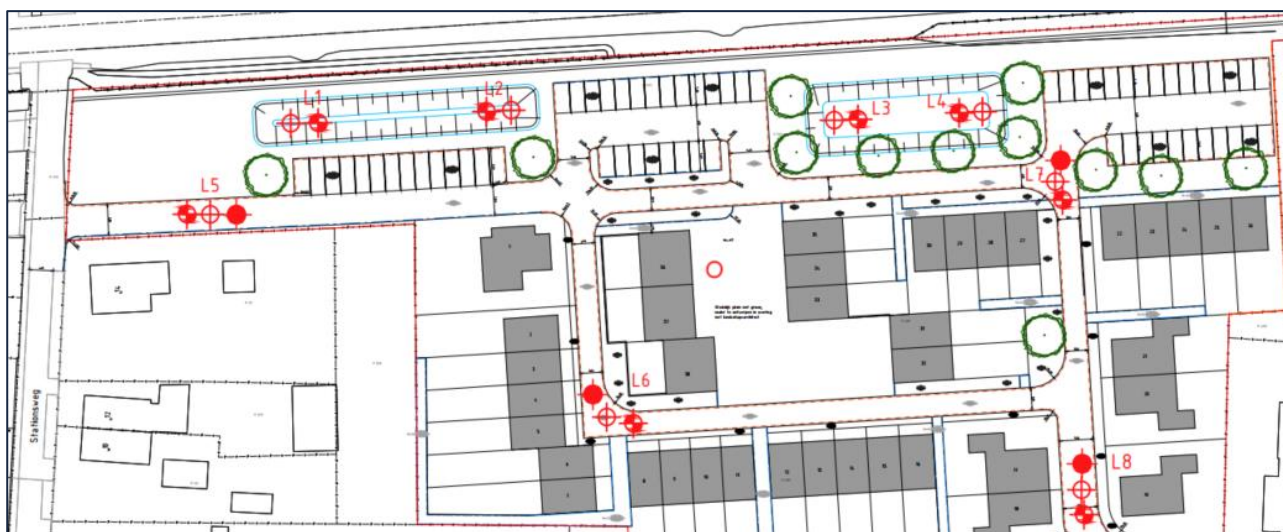
Afbeelding 2: Uitsnede uit tekening P02450-SO-VH-01-C01 van de projectlocatie met de toekomstige situatie en de locaties van de boorpunten (bron [2])
