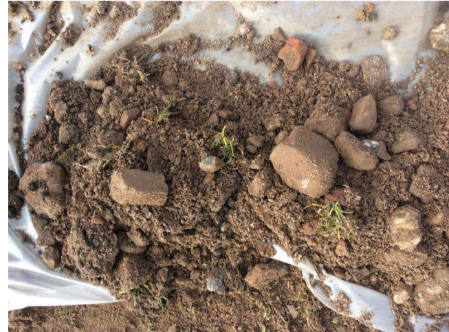
meetpunt 09, laag 0-15, bijz. metselwerkgranulaat 20154085
