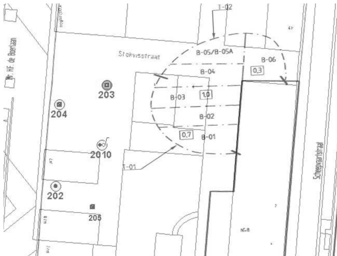
Figuur 5.1 Overzicht van aangetroffen verontreiniging met PAK in de grond en uitgevoerde ontgraving in 2013
