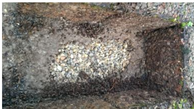
Figuur 22: Verbrijzeld voegmateriaal
