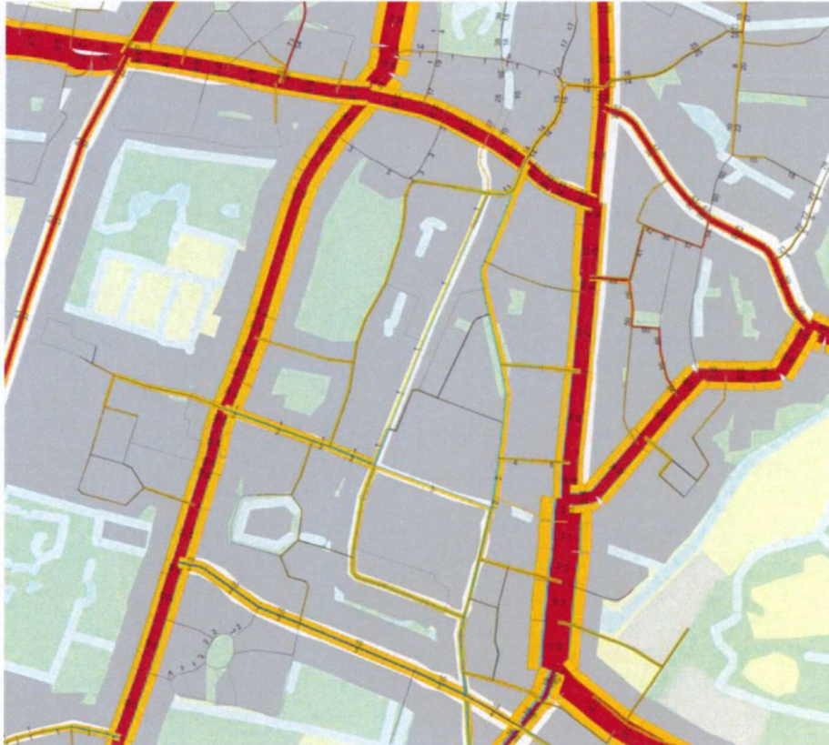
Figuur 3.1: InExDo-analyse (intern verkeer: blauw, extern verkeer: geel en doorgaand verkeer: rood)
