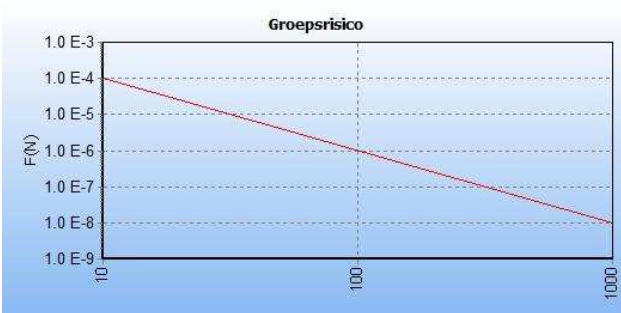
Figuur 9 FN-curve van de kilometer met de hoogste overschrijdingsfactor van gastransportleiding N-557-30 in de huidige situatie. De ligging van deze kilometer is hiernaast in het groen weergegeven op een topografische kaart.
