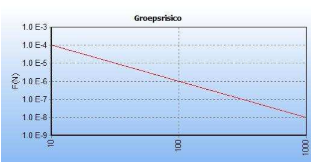
Figuur 13 FN-curve van de kilometer met de hoogste overschrijdingsfactor van gastransportleiding N-557-30 in de toekomstige situatie. De ligging van deze kilometer is hiernaast in het groen weergegeven op een topografische kaart.
