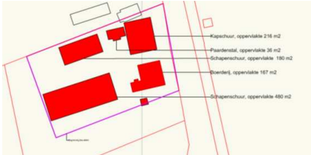
Afbeelding - Overzicht te slopen gebouwen aan de Molenweg 10
