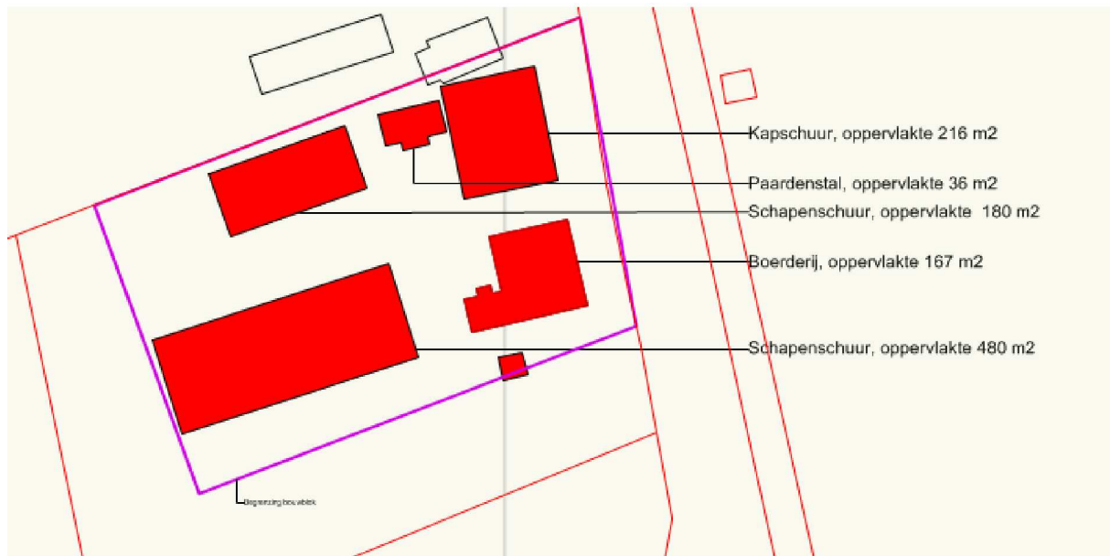
Overzicht te slopen gebouwen
