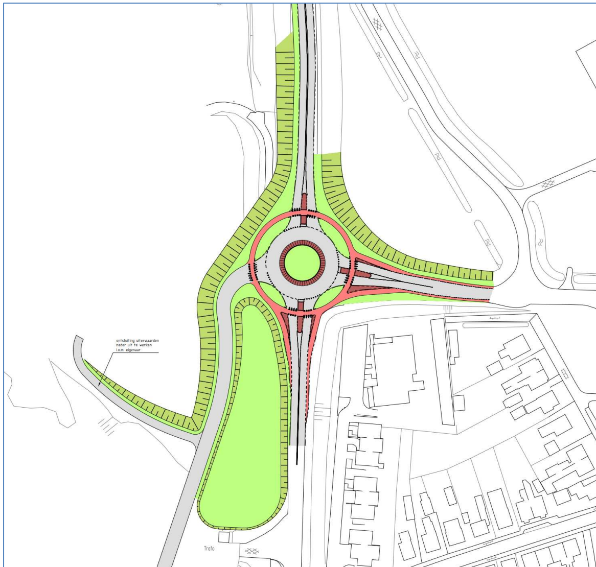
Figuur 25 Voorlopig ontwerp aansluiting N337 - De Meente als rotonde met aangepaste ontsluiting uiterwaarden
