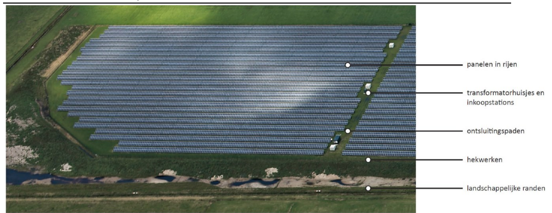
Figuur 1 Elementen van een zonnepark.
