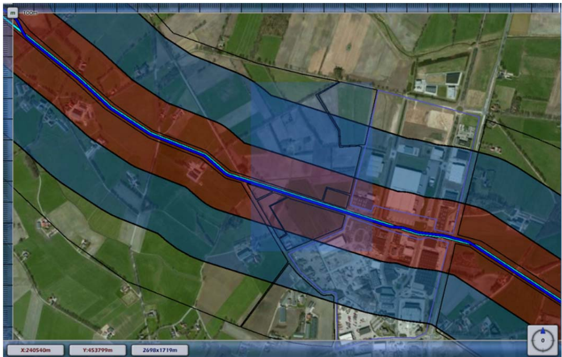
Afbeelding 4. Aardgastransportleiding A-628 en de bijbehorende effectafstanden
