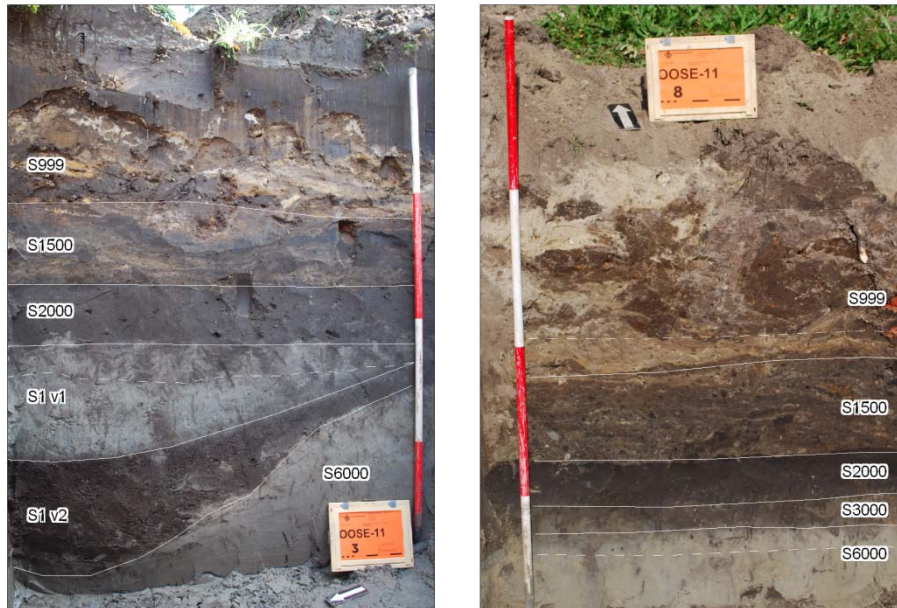
Afb. 5. Opbouw van bodem in profielkolommen. Links: profiel B. Rechts: put 2 kolom 1.
