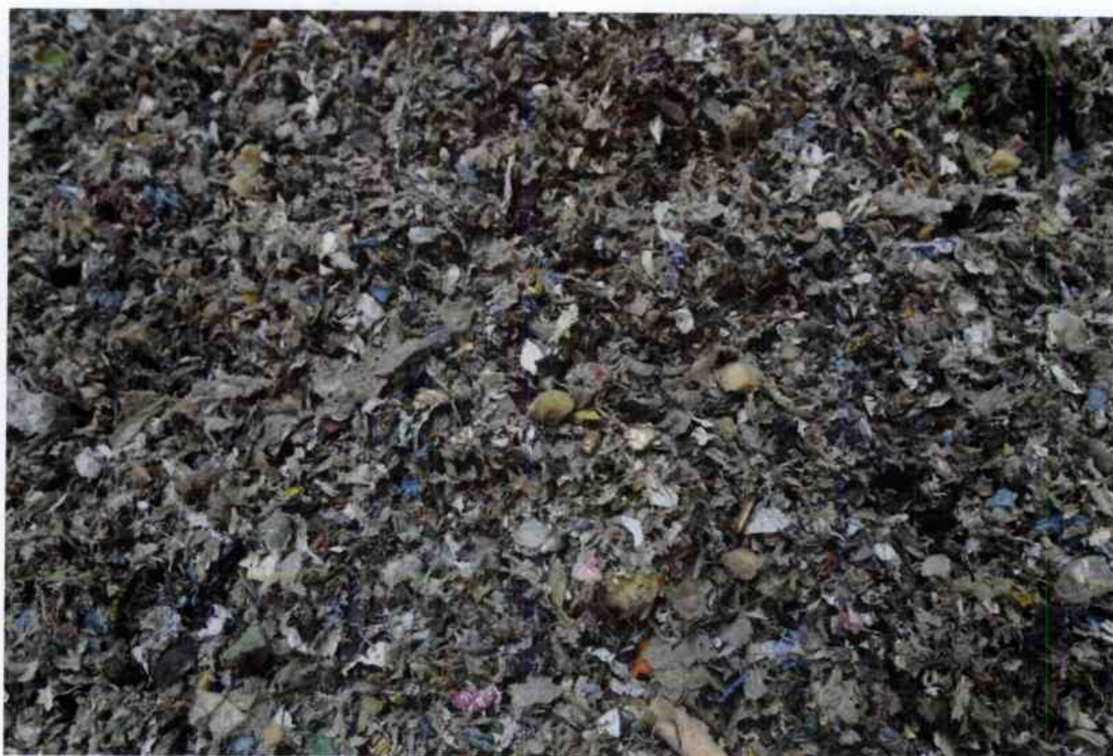
Afbeelding 3.3 Eindproduct Albra-installatie (hoogcalorisch materiaal Fluff)
