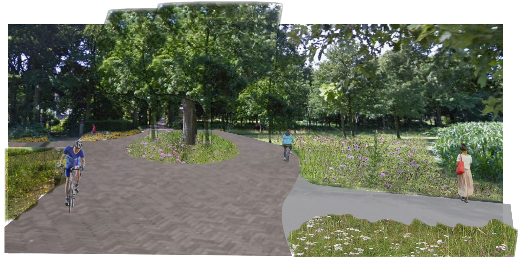
Verbijzondering kruispunt Raamsweg - Wechelerweg door splitsing, vernauwing en vergroening. Toepassing van kruidenrijk bloemenmengsel, bijvoorbeeld G2 mengsel met soorten als Duizendblad, Knoopkruid, Kleine ratelaar en Boerenwormkruid (zie ook p.38).
