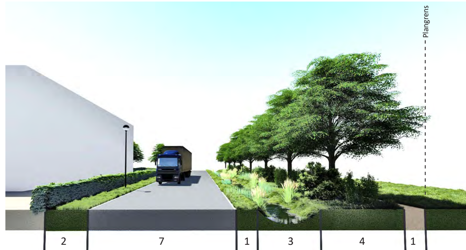
Doorsnede over oostelijk groenstrook (Lentheweg): 5 meter brede groenstrook met bomenlaan en struinpads beëindigen het bedrijventerrein zaksloot voert het water naar de waterberging aan de noordzijde
