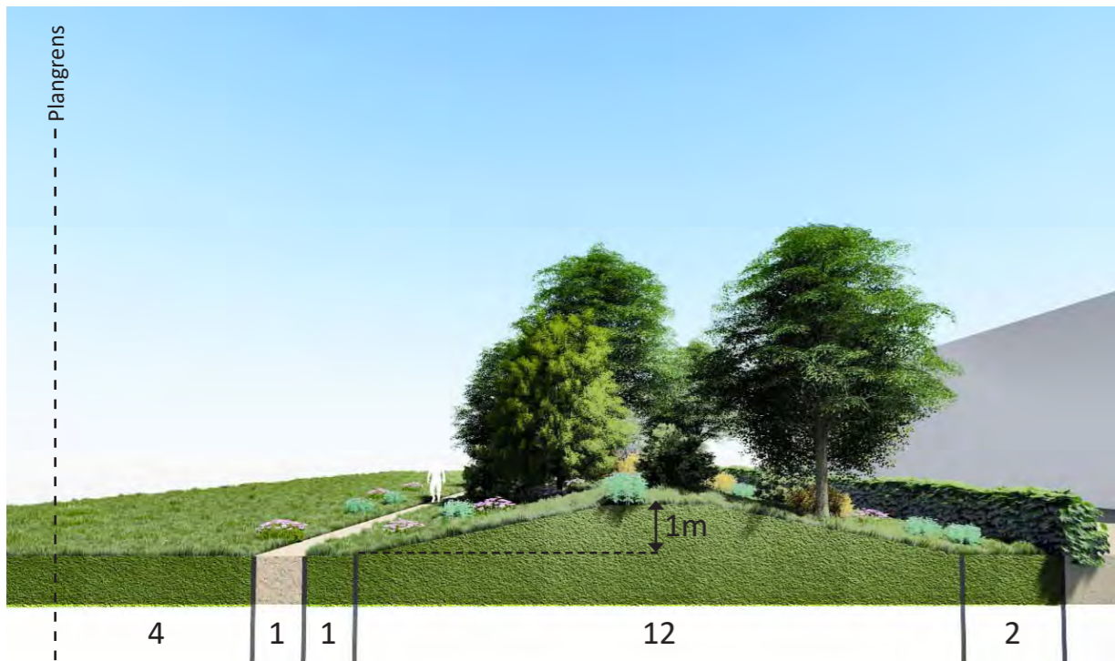
Doorsnede over houtwal: struinpad kijkt over de weilanden heen houtwal schermt het bedrijventerrein af
