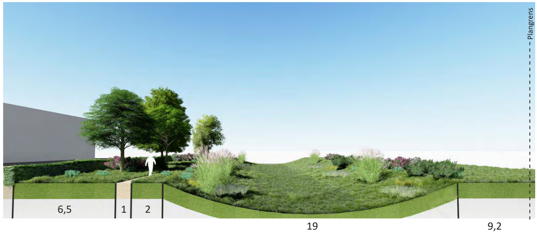
Doorsnede over noordelijke groenstrook: struinpad loopt meanderend tussen het bedrijventerrein en de waterberging (droogvallende wadi) de talud zijn flauw en worden ingericht met natuurvriendelijke oevers representatieve voorzides van de bedrijven zijn op de N35 gericht
