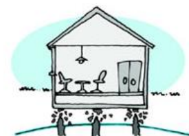
Grondwaterpeil te laag: paalrot
