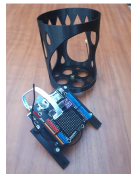
3D geprint frame m.b.v. BIO-plastic
