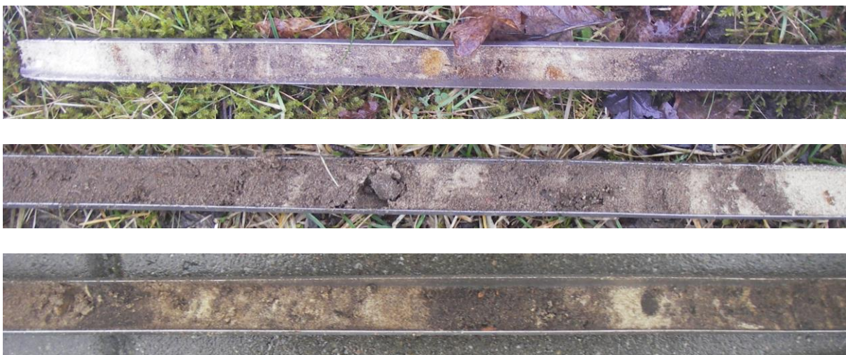
Figuur 16 a, b, c: Drie voorbeelden van de sterk verstoorde bovenlaag zoals deze in alle boringen is aangetroffen.
