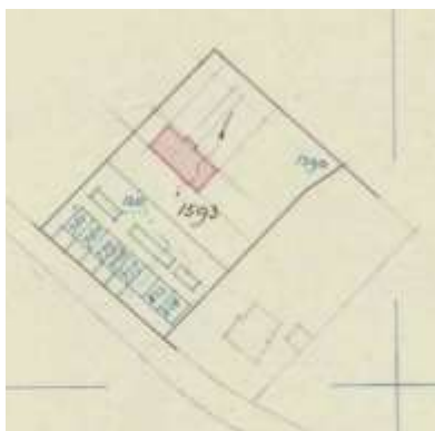
Afb. 2.21 Het ontwerp voor de vruchtenkas, als bijlage bij de vergunningsaanvraag. Op de plattegrond links (noord) de perzikkas en rechts (zuid) de druivenkas. GAZ, bouwloket, vergunningaanvraag dd 1-11-1911
